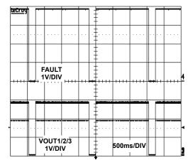
FIGURE 9. THERMAL SHUTDOWN OPERATION
