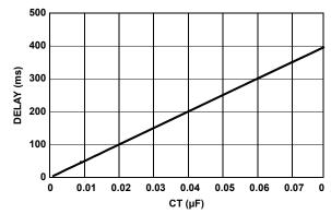
FIGURE 12. RESET DELAY vs CT CAPACITANCE
